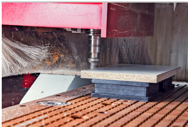
Ventosa de bloque VCBL-R fijando un tablero de madera aglomerada
